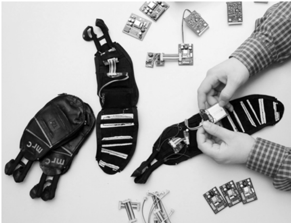
Abb. 7: Komponenten des optimierten Winspect-Eingabehandschuhs, 3. Generation (Bild: MRC)
