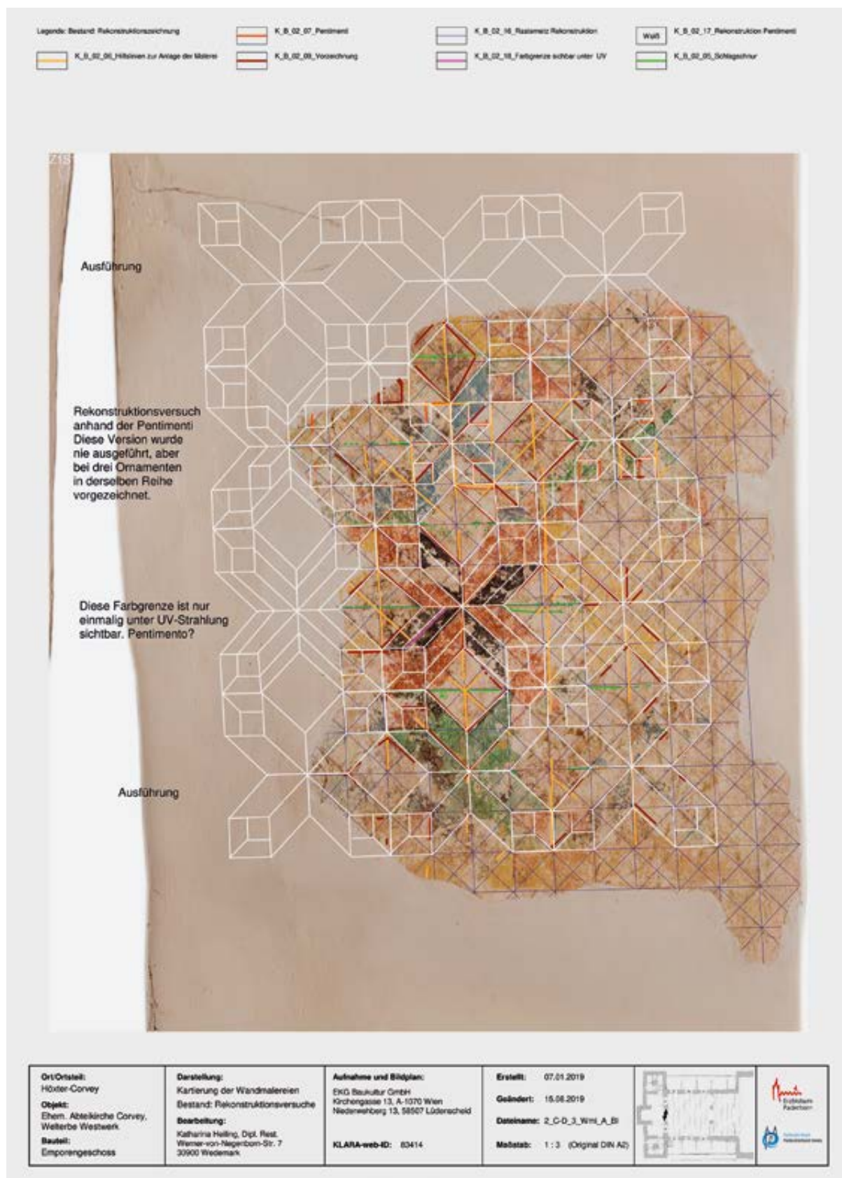
12 Ausschnitt der Kartierung des Kreuzornaments der Westempore, Mittelarkade, Südseite: Pentimenti und Werktechnik, Dokumentation Katharina Heiling, 2019
