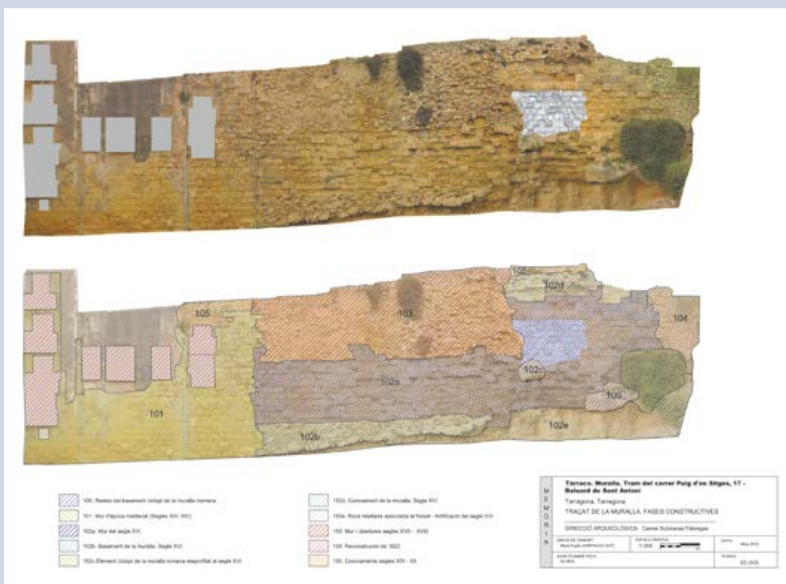
23 Laser scanner survey and chronological study of the history of a section of the ramparts of the bastion of San Antonio Levantamiento escáner laser y estudio de fases cronológicas del tramo de muralla del baluarte de San Antonio
